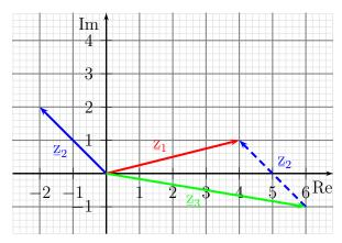
durchlaufen wird. Das geschieht hier dadurch, dass seine Spitze an die Spitze von  $\underline{z}_1$  angelegt wird. Sein Anfang liegt dann an der Spitze des Ergebniszeigers  $\underline{z}_3$ . Das Ergebnis prüfen wir nun durch eine Rechnung:
